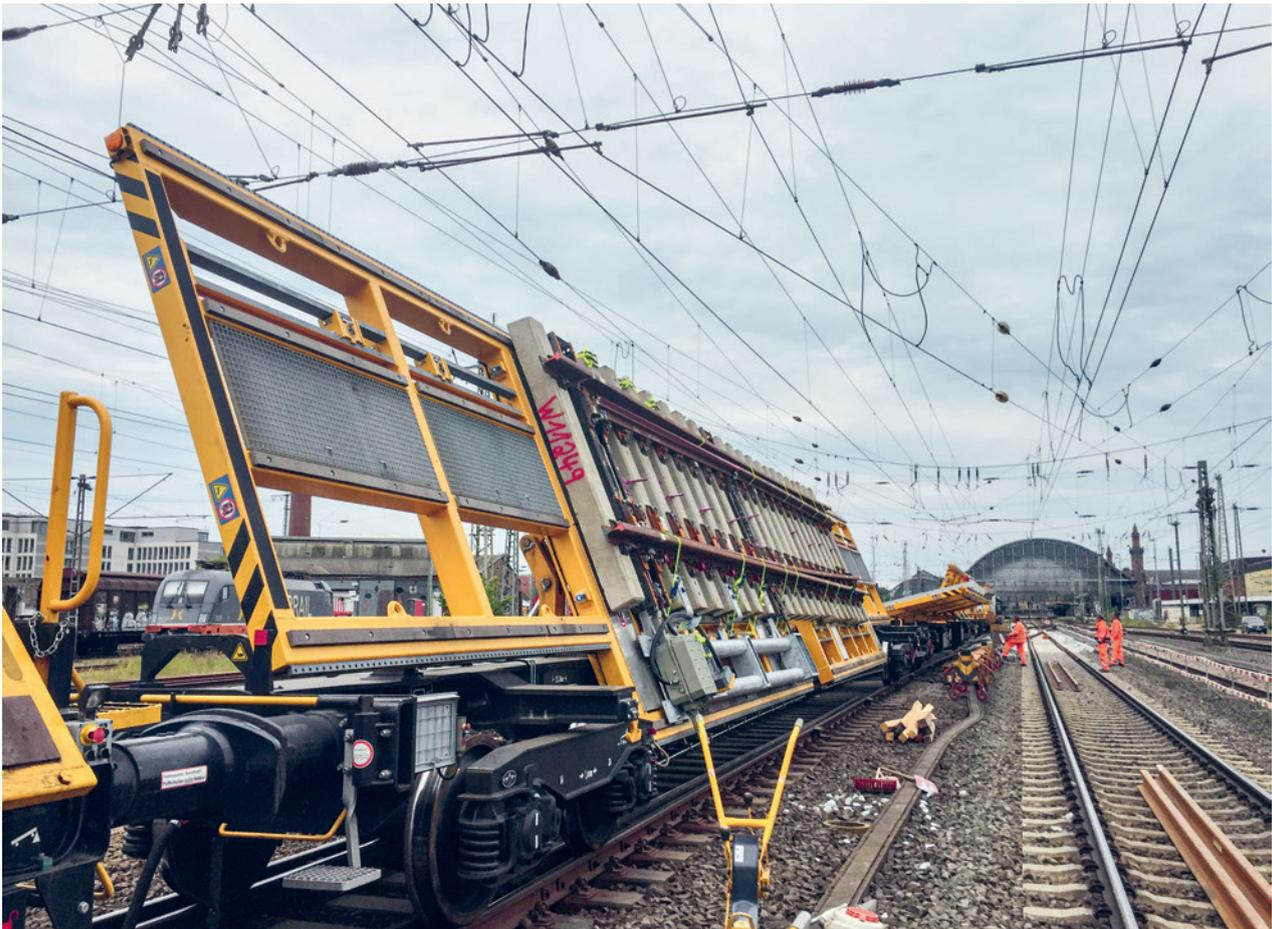
Der Switch Tilter ist der perfekte Weichentransportwagen für den modularen Weichenwechsel.
