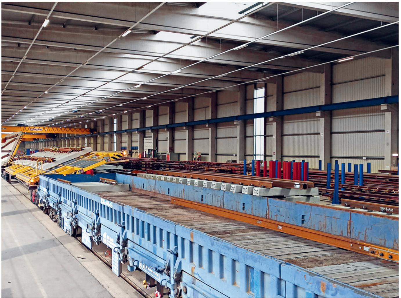
Im Weichenwerk werden die vormontierten und getesteten Weichensegmente während einer Normalschicht auf die Switch Tilter verladen.
