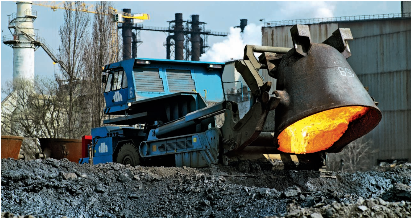
↑ Slag Taurus P mit konventionellem Kippsystem
