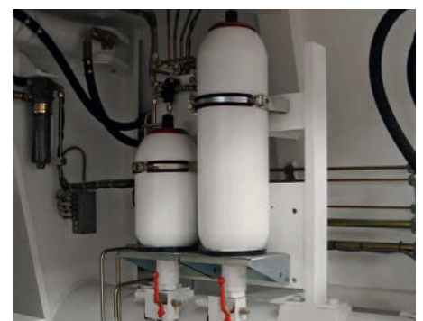
↑ Hydropneumatische Speicher für die Bremsanlage
