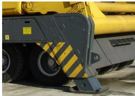
↑ Integrierte Abstützung mit geschütztem Abstützzyylinder
