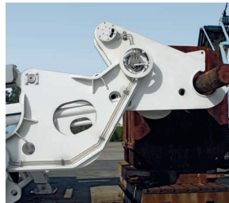
↑ Slag Taurus P mit Koppelstangenkippsystem
