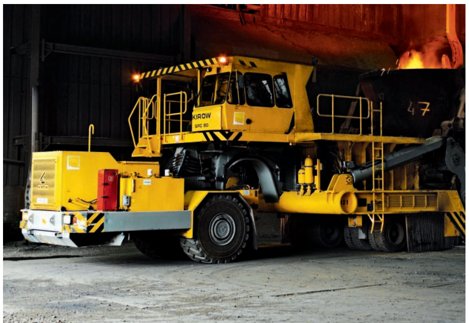
↑ Die Powerzentrale des Slag Taurus: der Triebkopf
