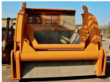
↑ Umfangreiche Schutzverkleidungen am Slag Taurus P
