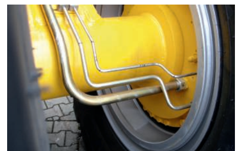
↑ Nasse Lamellenbremsen in gekapselter Bauweise
