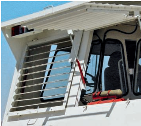
↑ Großflächige Lamellensichtfenster am Schutzdach
