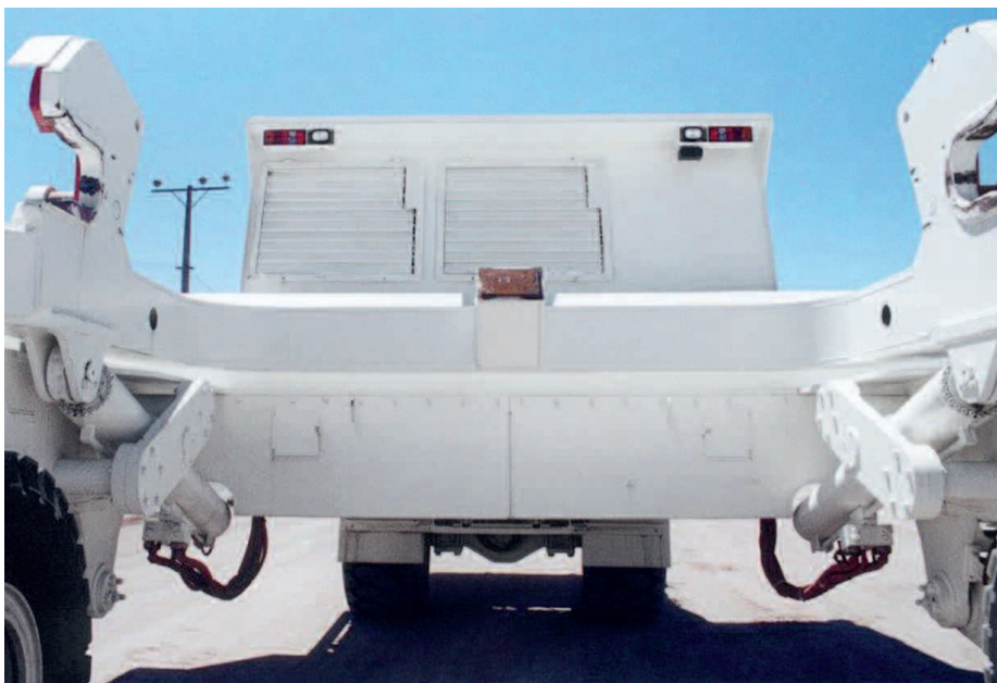
↑ Umfangreiche Schutzverkleidungen am Slag Taurus U
