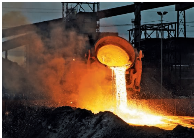
Typische Kippsituation am Schlackenbeet
