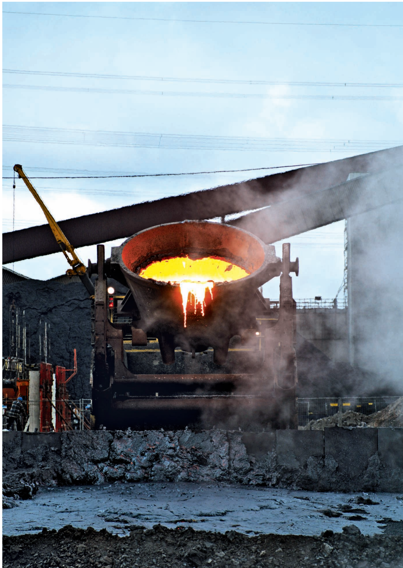
↑ Der zuverlässige Slag Taurus: beginnender Kippvorgang
