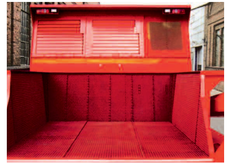
↑ Option Feuerfest-Vorbereitung: Um die Sicherheit bei Pfannendurchbrüchen zu erhöhen, lässt sich die Plattform des Lastteils für die Ausmauerung mit Feuerfest-Beton vorbereiten.
