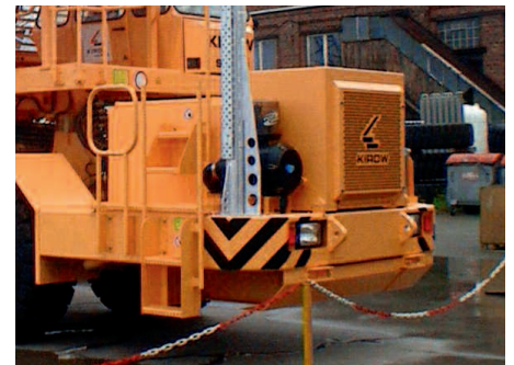
↑ Option Abgasführung nach oben: für den Hallenbetrieb
