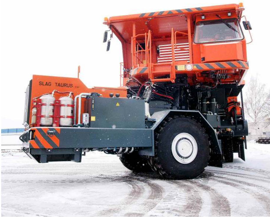
↑ Optimale Anordnung der Fahrerkabine: unabhängig von Lenkbewegungen
