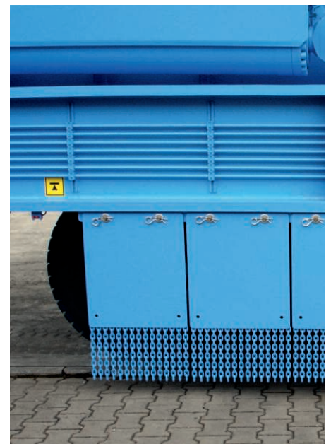
↑ Option Hinterachse-Kettenschutz: zum Schutz vor Schlackenspritzern
