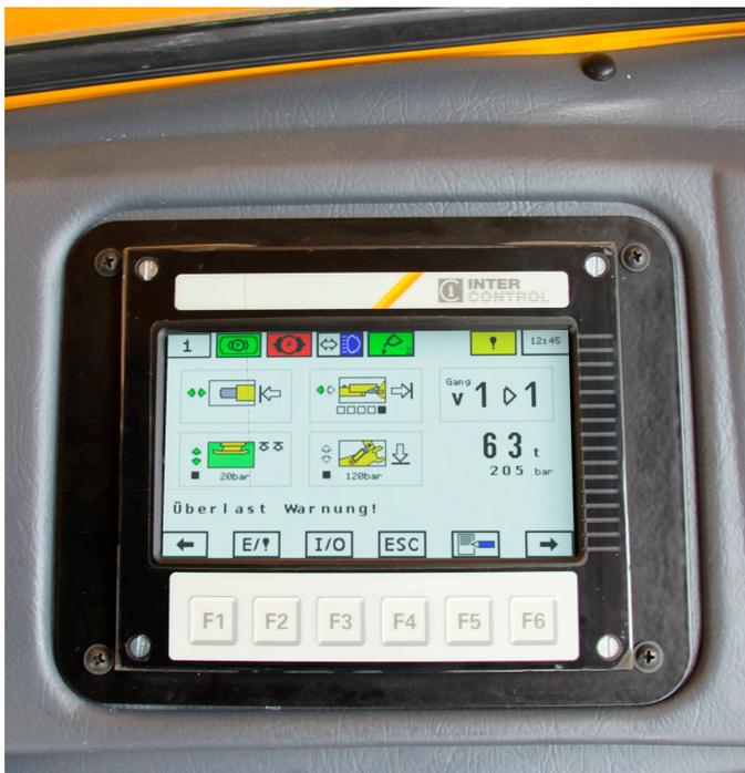
↑ KISS (Sistema de Seguridad Integrado de KIROW) – Sistema de seguridad con monitoreo de todas las funciones del carrier visibles en el interior de la cabina
