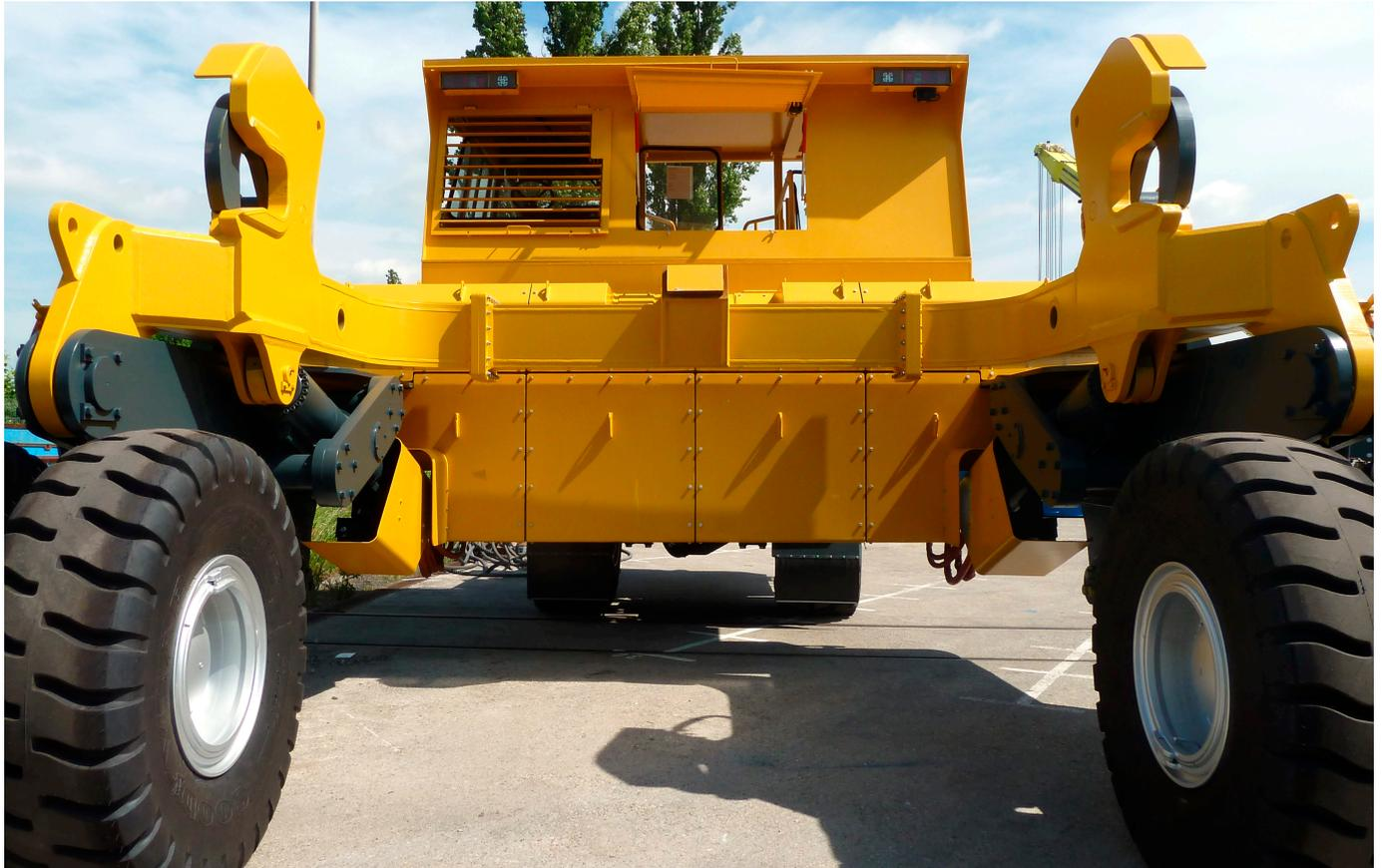
↑ Protecciones de seguridad extendidas en el tráiler – Estas protecciones cubren áreas sensibles del tráiler de las salpicaduras de escoria, por ejemplo cilindros hidráulicos o mangueras
