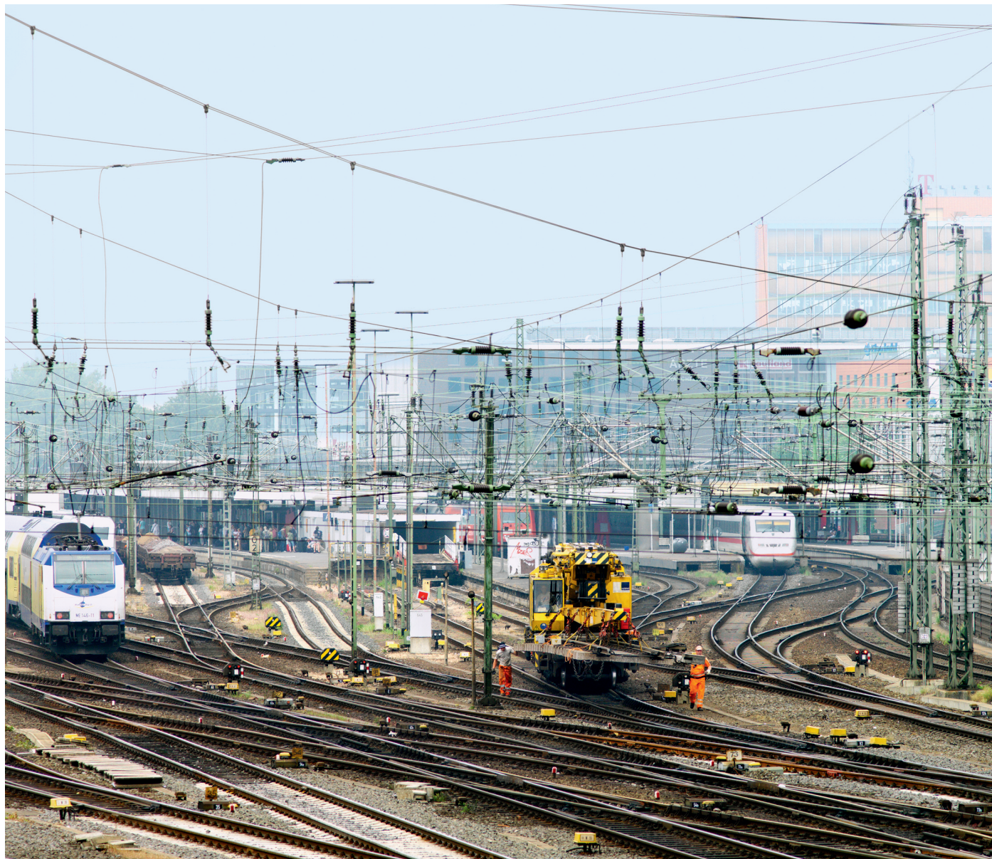
↑ Телескопическая стрела и незначительный задний вылет делают Multi Tasker непревзойденно подвижным на станциях
