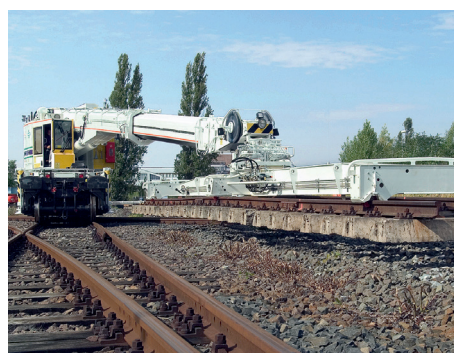
↑ Элементы пути могут транспортироваться с помощью гидравлических траверс
