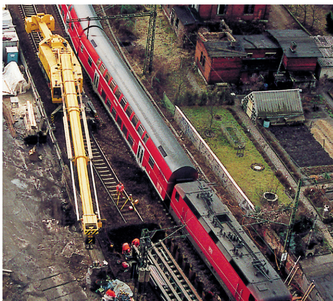
↑ Специальное устройство противовеса Multi Tasker позволяет работать в габарите с одной опорой.
