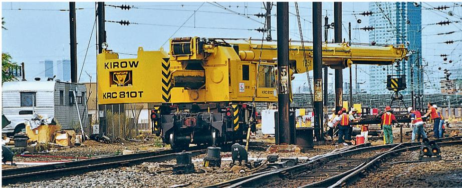
↑ Lança telescópica para alta flexibilidade de aplicação
