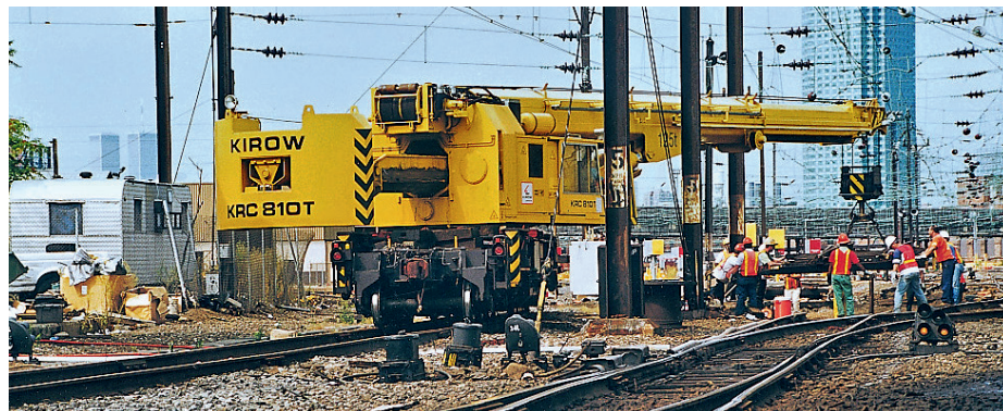
↑ Flèche télescopique pour une grande flexibilité d'intervention
