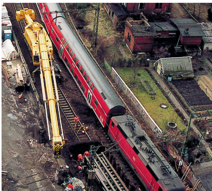
↑ L'agencement particulier des contrepoids sur le Multi Tasker permet de réaliser des travaux sans obstacle avec seulement une béquille.
