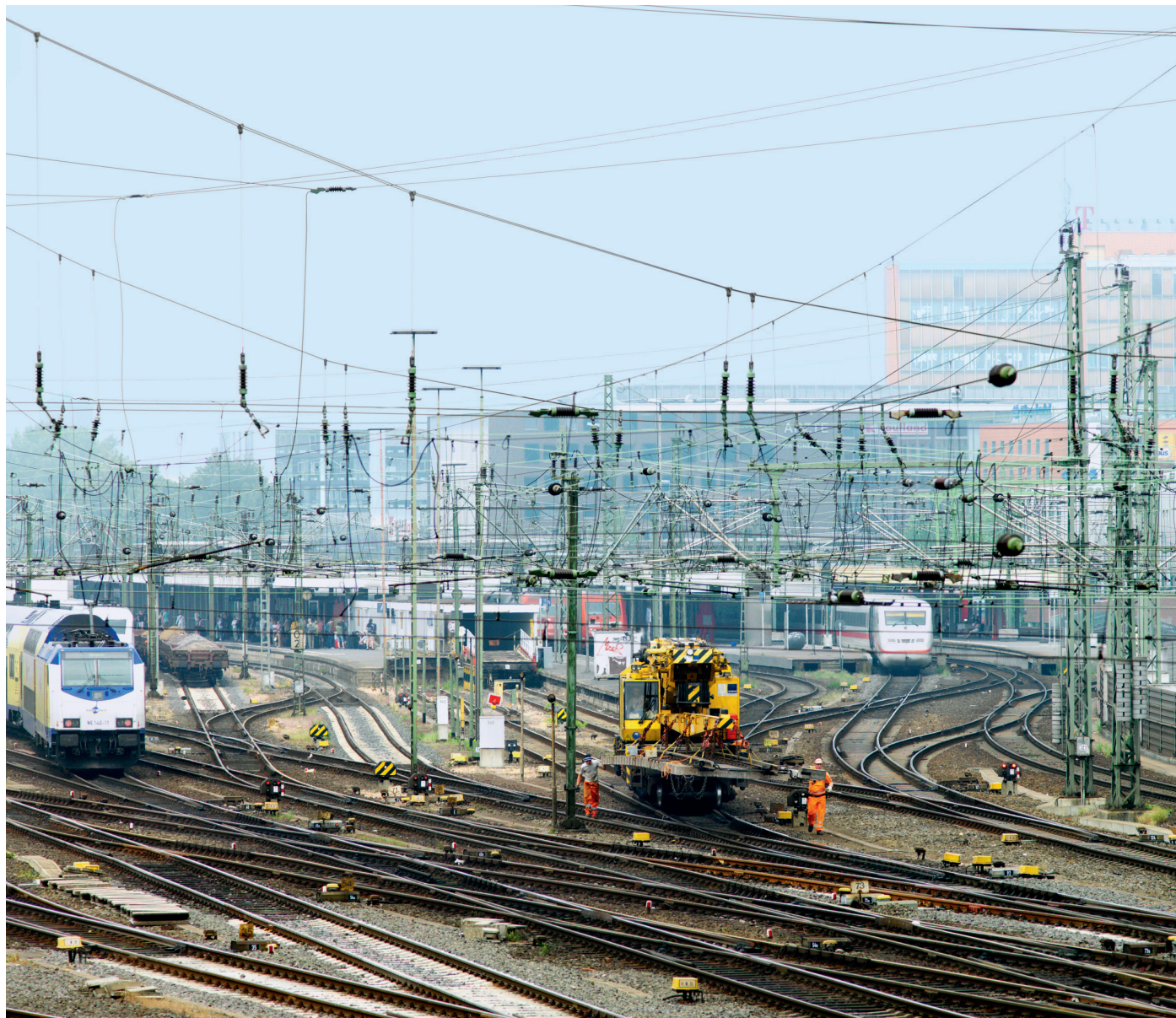
↑ La flèche télescopique et la portée arrière réduite rendent le Multi Tasker exceptionnellement agile dans les gares
