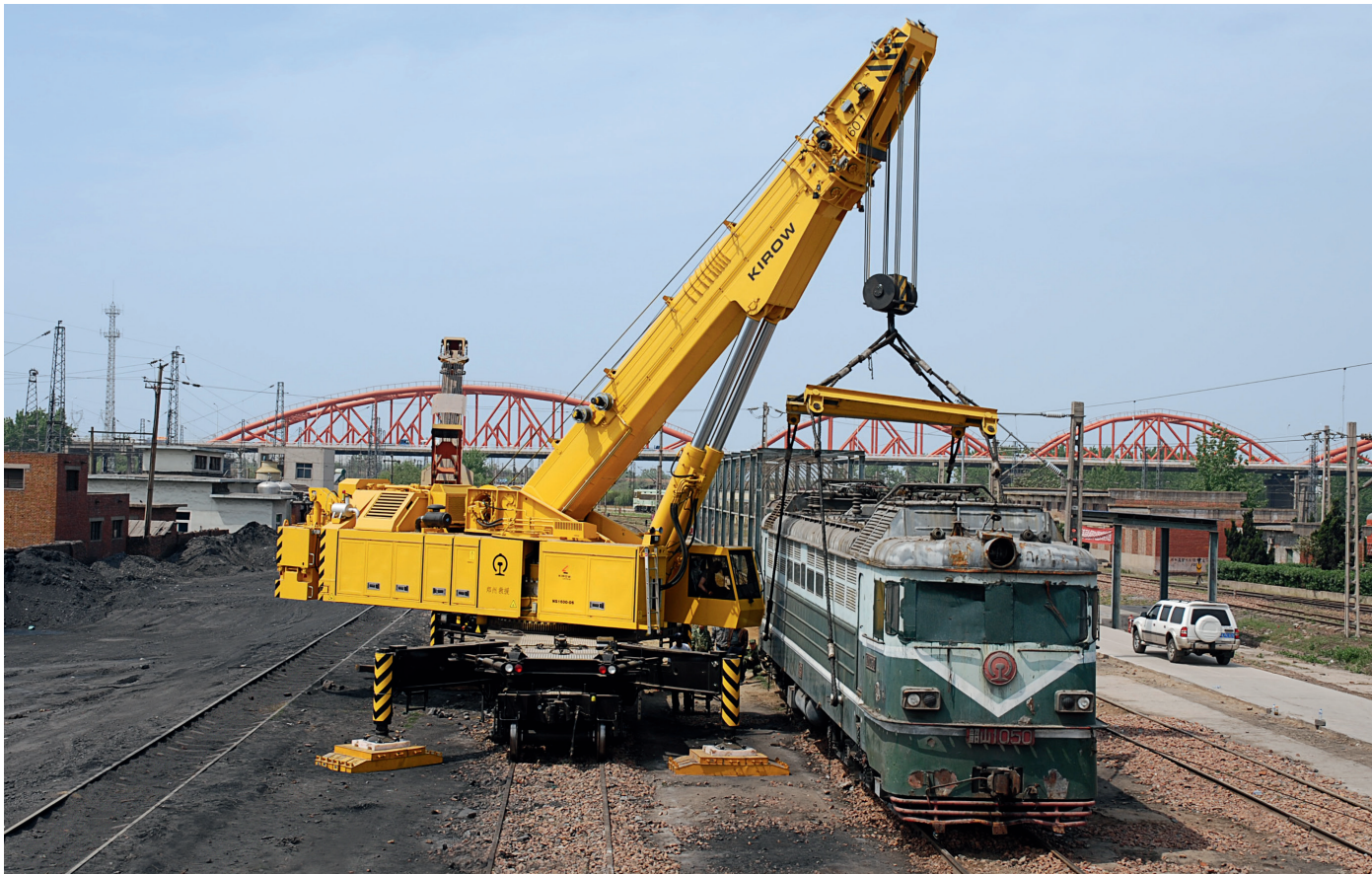
Multi Tasker 1600 completamente apoyada
