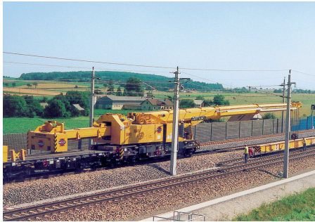
↑ Tendido de tramos de vía en espacios limitados
