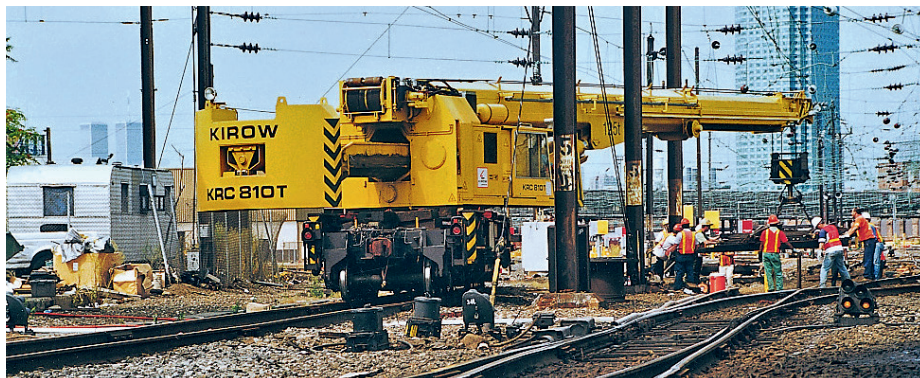
↑ Pluma telescópica para una gran flexibilidad de empleo
