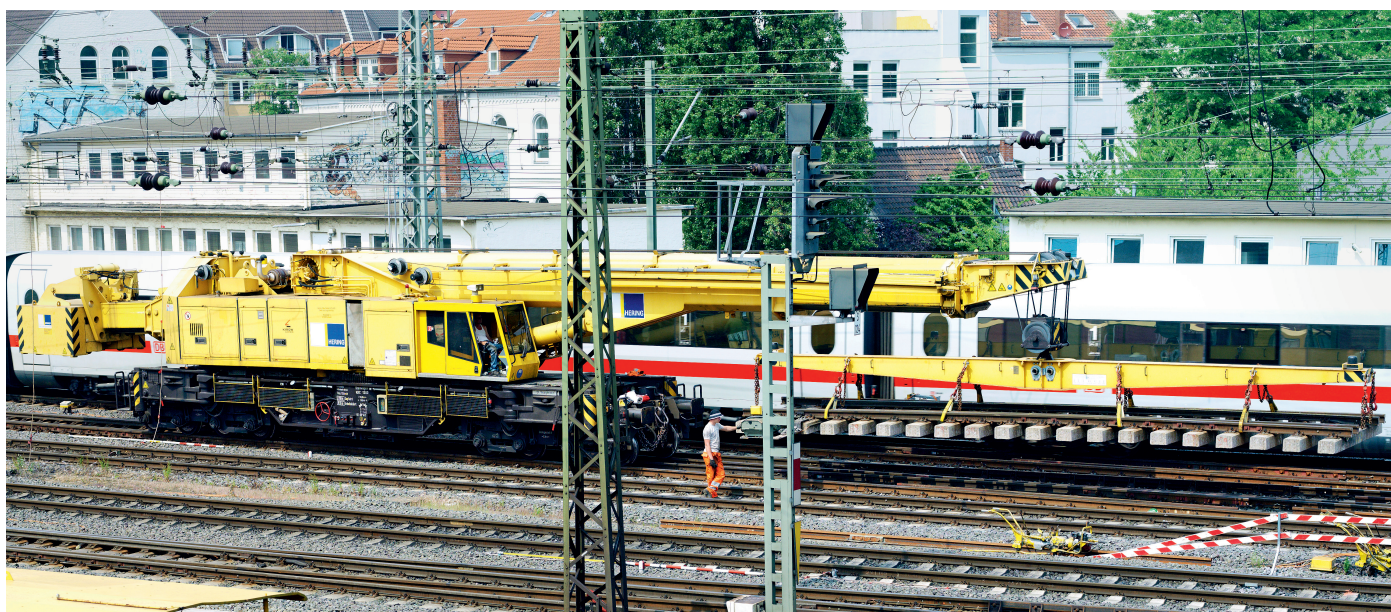
↑ Trabajar y desplazarse. La Multi Tasker no obstaculiza el tráfico ferroviario
