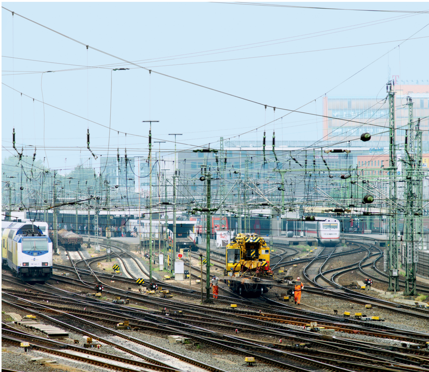
↑ Su pluma telescópica y el pequeño radio trasero hacen de la Multi Tasker una grúa excepcionalmente ágil en estaciones ferroviarias
