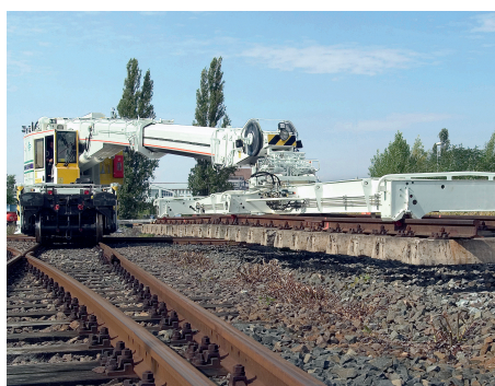
↑ Los tramos de vía pueden moverse con travesaños hidráulicos
