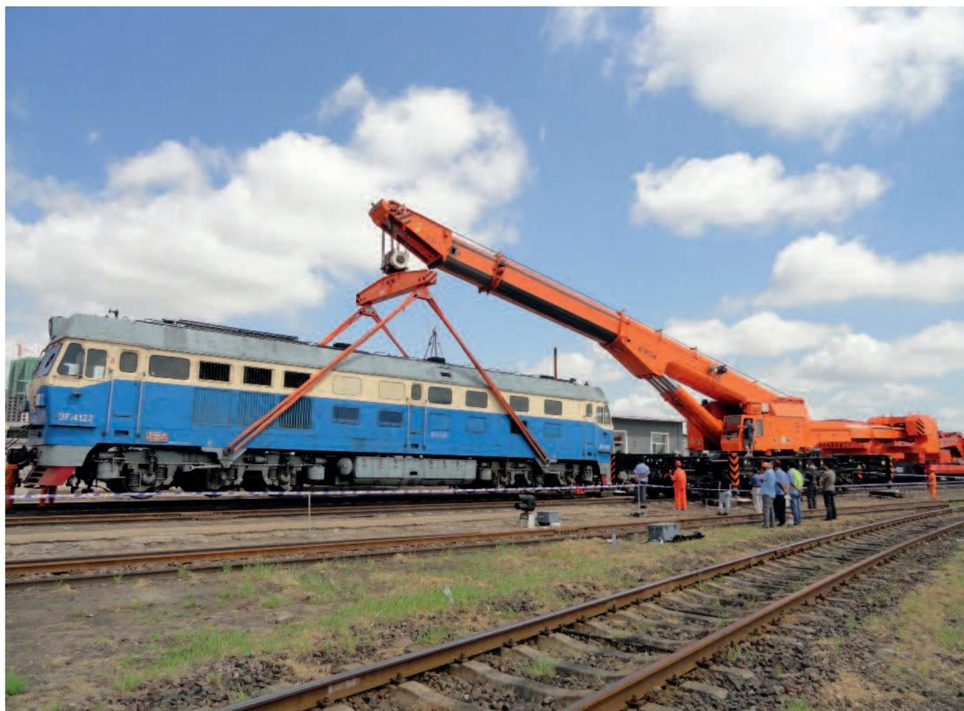
\*BEI EISENBAHNEN MIT NIEDRIGER BAUHÖHE ODER KLEINEM LICHTRAUMPROFIL LASSEN SICH GEWISSE TRAGFÄHIGKEITEN NUR MIT KRANEN REALISIEREN, DIE EIN MITDREHENDES GEGENGEWICHT HABEN. FÜR RÜCKFRAGEN STEHEN WIR IHNEN SELBSTVERSTÄNDLICH JEDERZEIT ZUR VERFÜGUNG.
