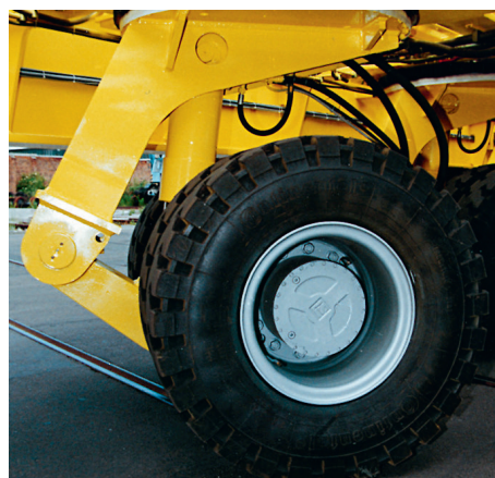
↑ Поворотная тележка Multi Mover
