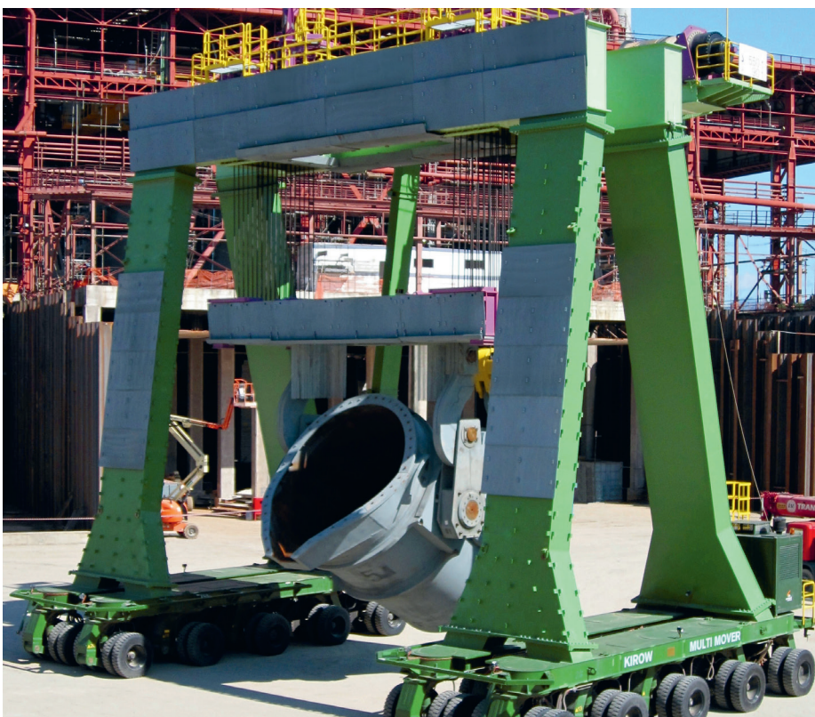
↑ Multi Mover Y: мобильный кран для подачи разливочного ковша
