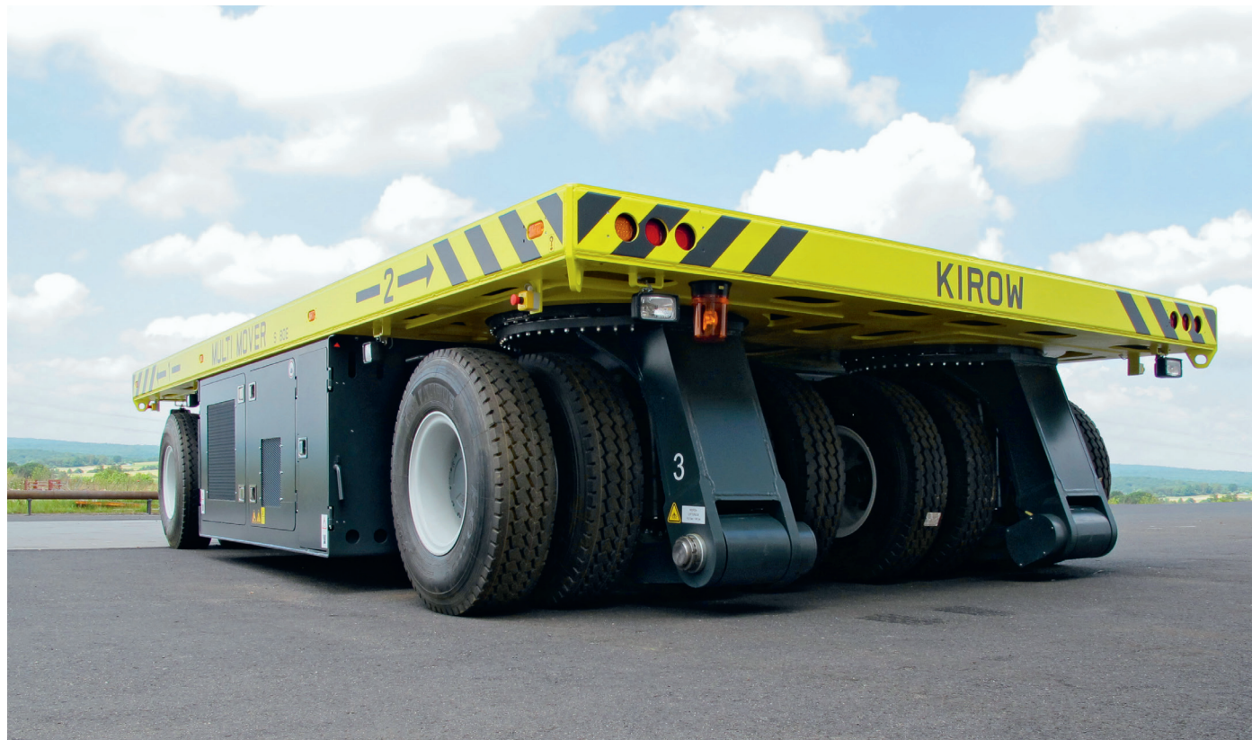
↑ Mini Mover: небольшие габариты и аккумуляторный гидропривод
