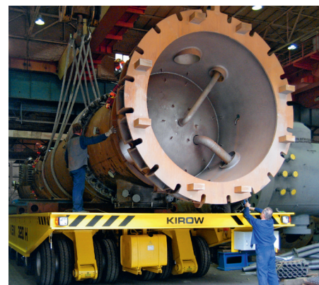
Транспортировка тяжёлого узла без платформы
