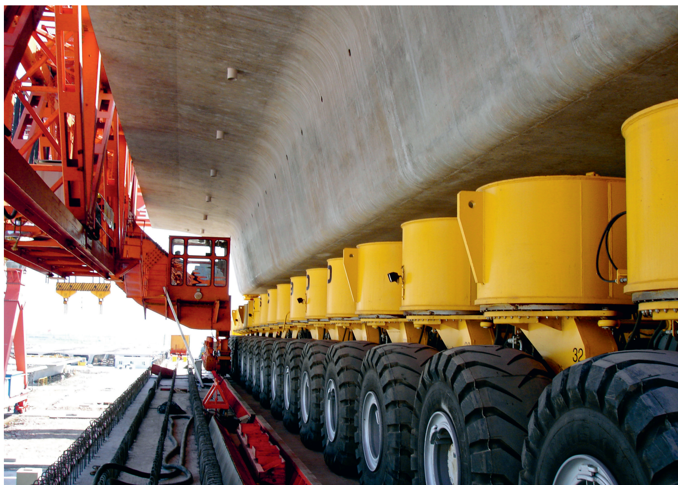
↑ Multi Mover C: эффективен и быстр при доставке крупногабаритных тяжёлых грузов, например, на строительные площадки
