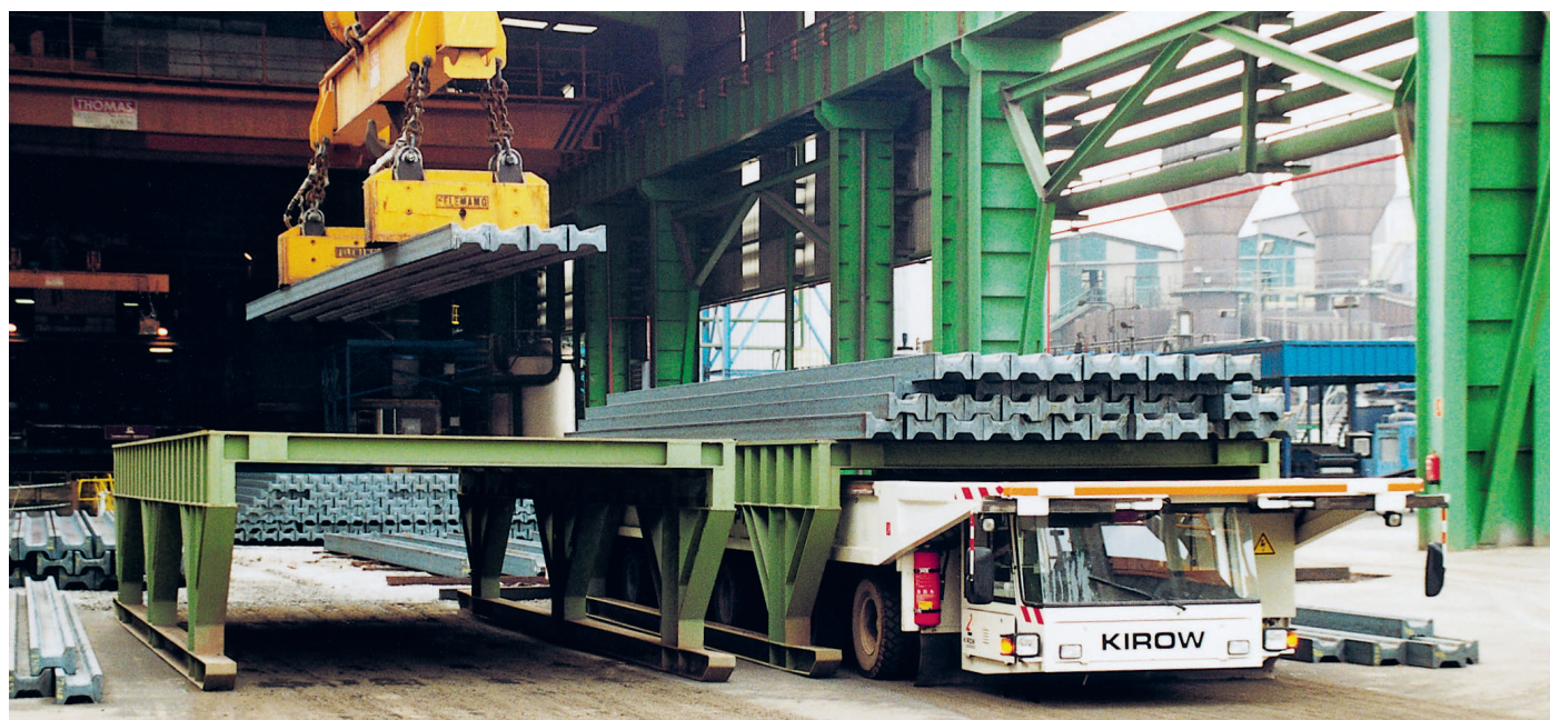
↑ Multi Mover M с нижней кабиной для длинномерных грузов
