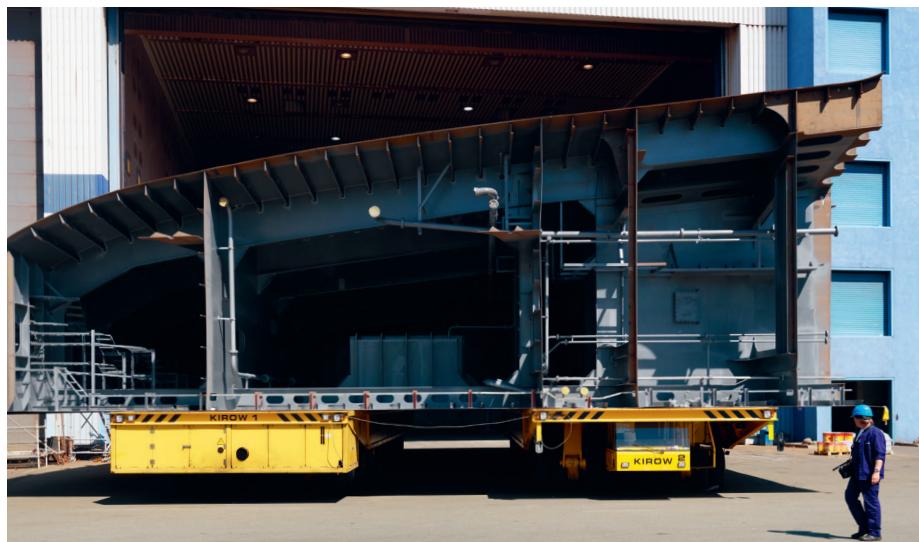
↑ Multi Mover S в сцепленном режиме работы: управление – дистанционно
