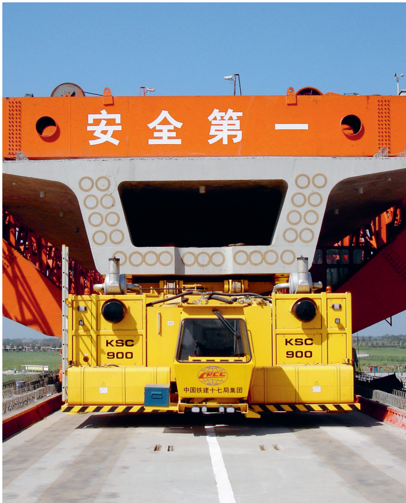
↑ MULTI MOVER C: транспортёр для перевозки готовых железобетонных балок
