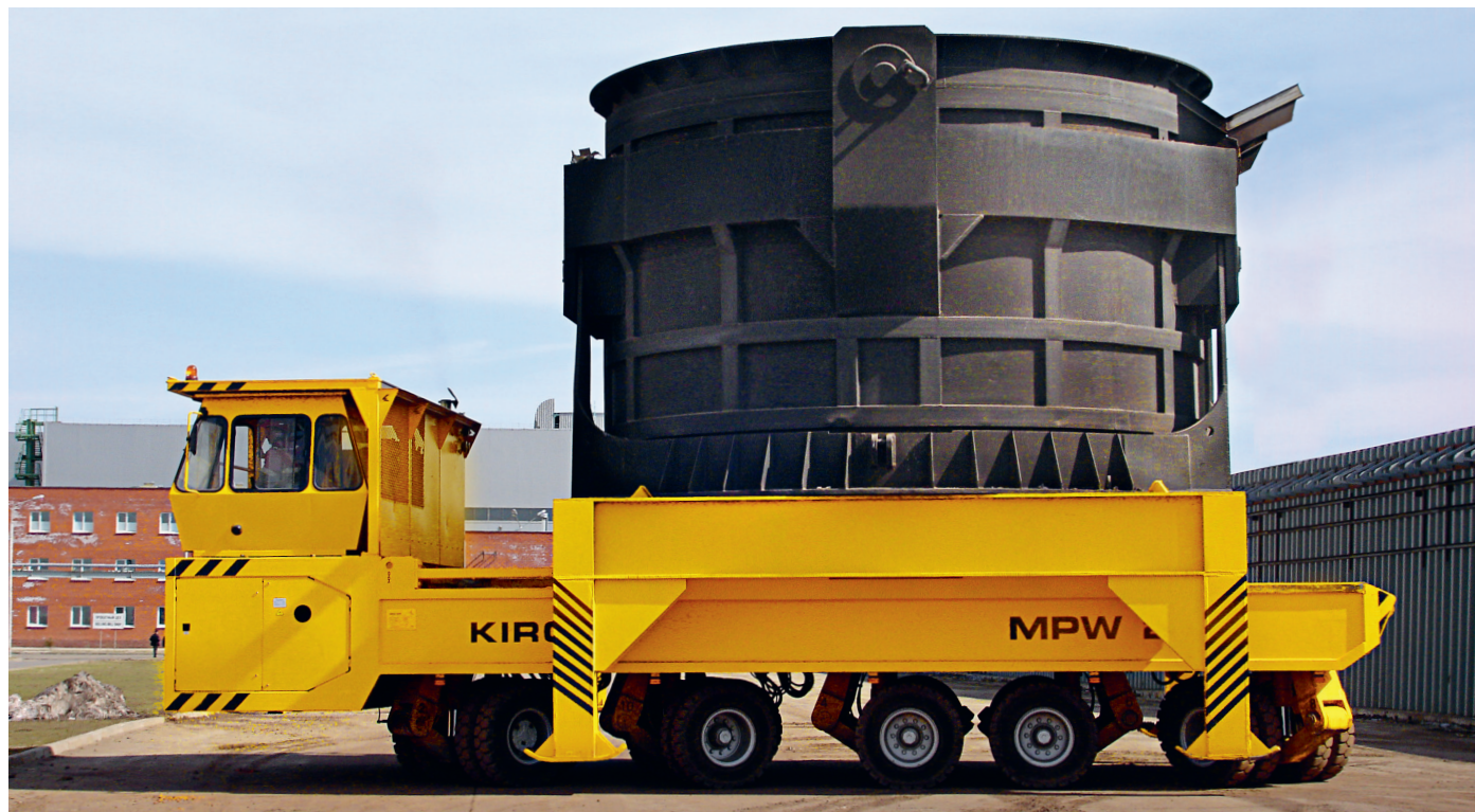
Multi Mover M с грузовой платформой и коробом для сбора скрапа
