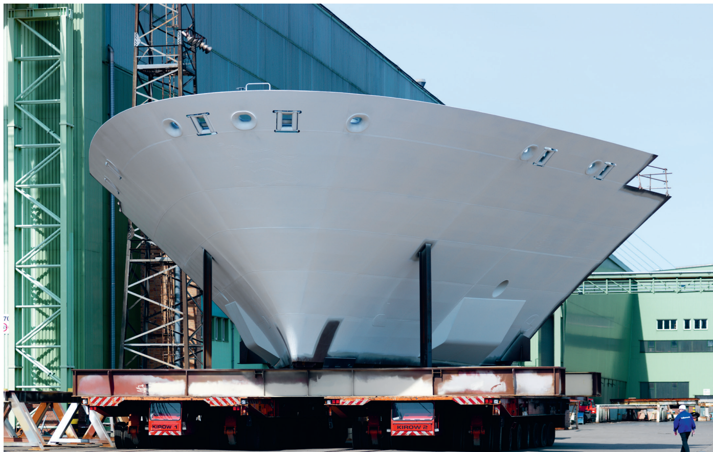
↑ Multi Mover S: спаренная транспортировка сегментов судна
