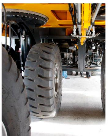
Fácil accesso debajo de la plataforma, gracias a las ruedas de 25 pulgadas, facilita los trabajos de mantenimiento.
