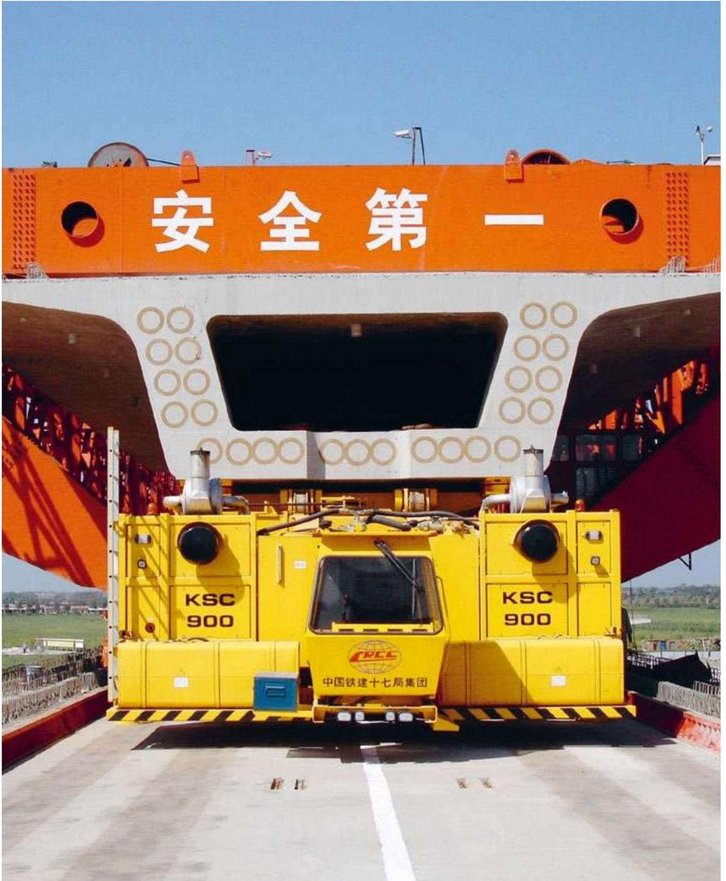
↑ Multi Mover C: Schwerlastfahrzeug zum Transport von vorgefertigten, bewehrten Betonträgern
