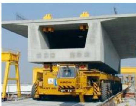
↑ Transport eines Brückenfertigteils mit 900 Tonnen
