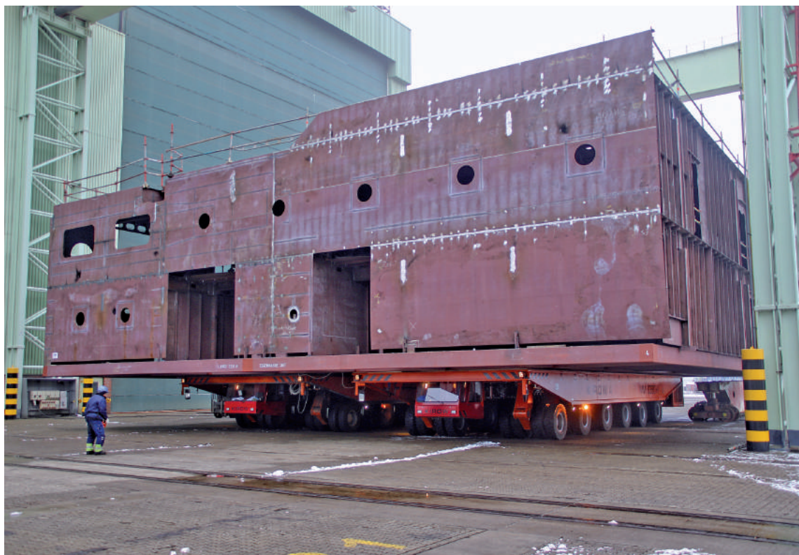
↑ Multi Mover S380H bei der ersten Koppelfahrt
