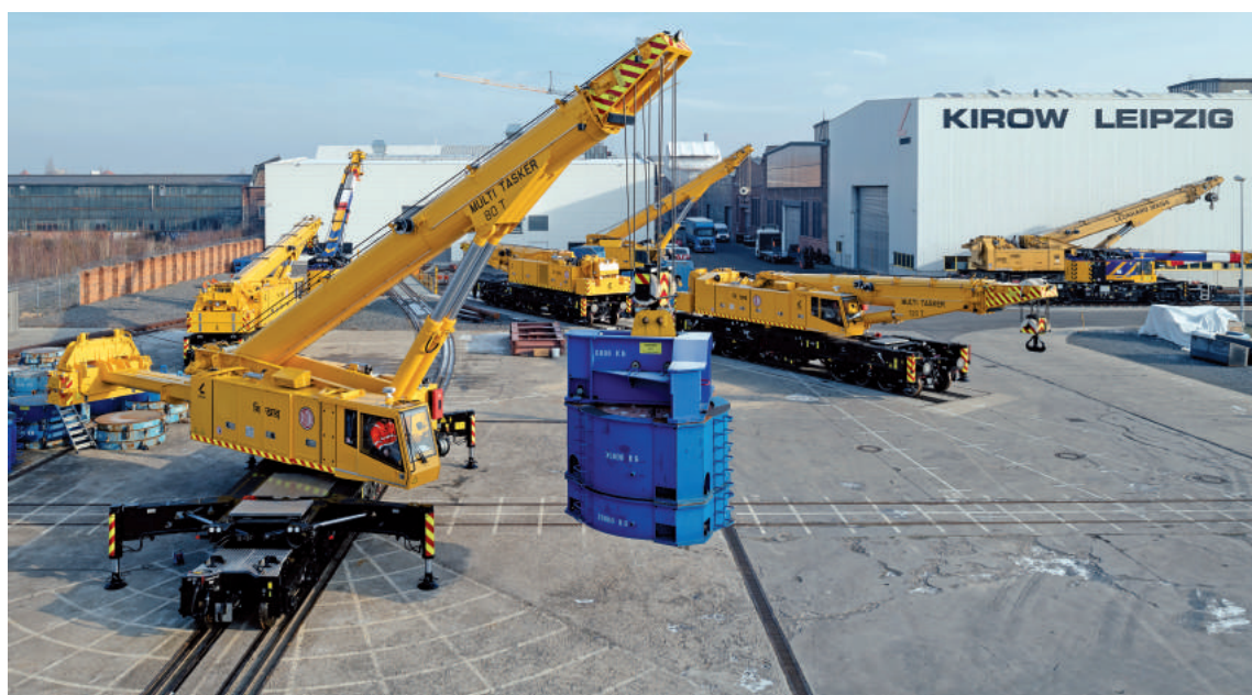
↑ Lasttest auf dem Prüffeld. Krane für Bangladesh.
