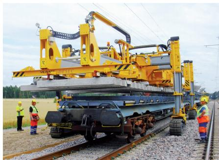
↑ Платформа для перевозки стрелки в горизонтальном положении для разгрузки с DESEC Tracklayer
