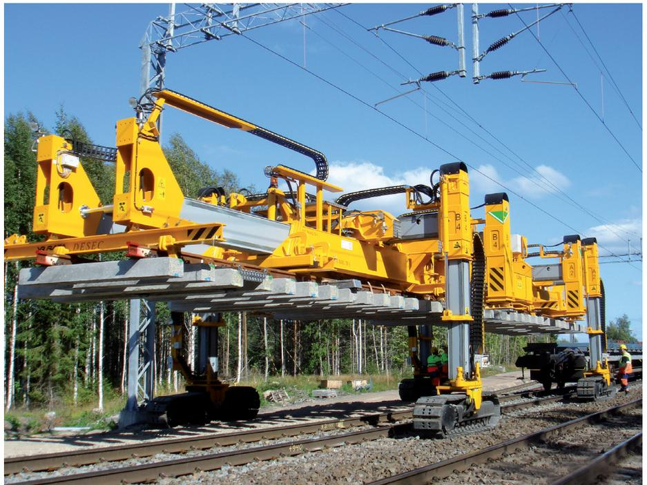
↑ DESEC Tracklayer отлично работает с наклонными платформами для перевозки стрелочных переводов в сборе
