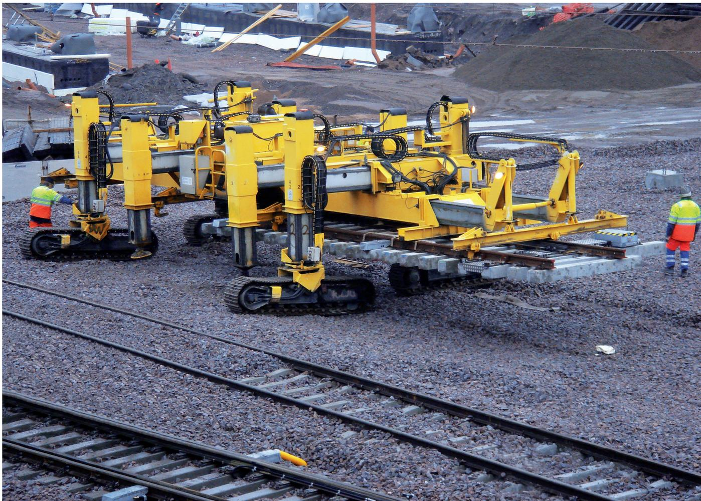
↑ Передвижение по неровному грунту вне железнодорожного полотна
