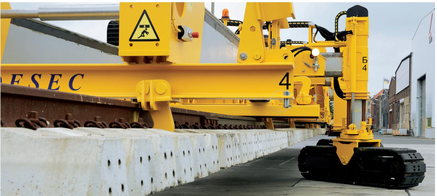
↑ Стрелочный перевод переносится без провисания или скручивания
