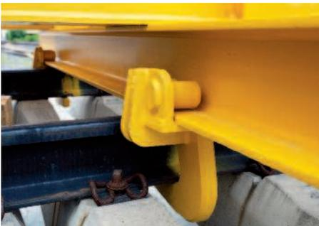
↑ Lasthaken greifen am Schienenfuß unter die Last
