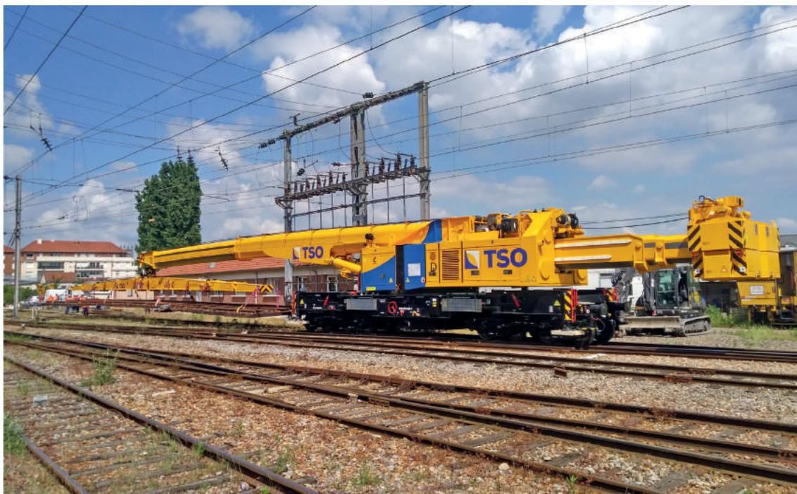
↑ Der Multi Tasker KRC 1200 hantiert mit Last, während er unter der Oberleitung arbeitet.
